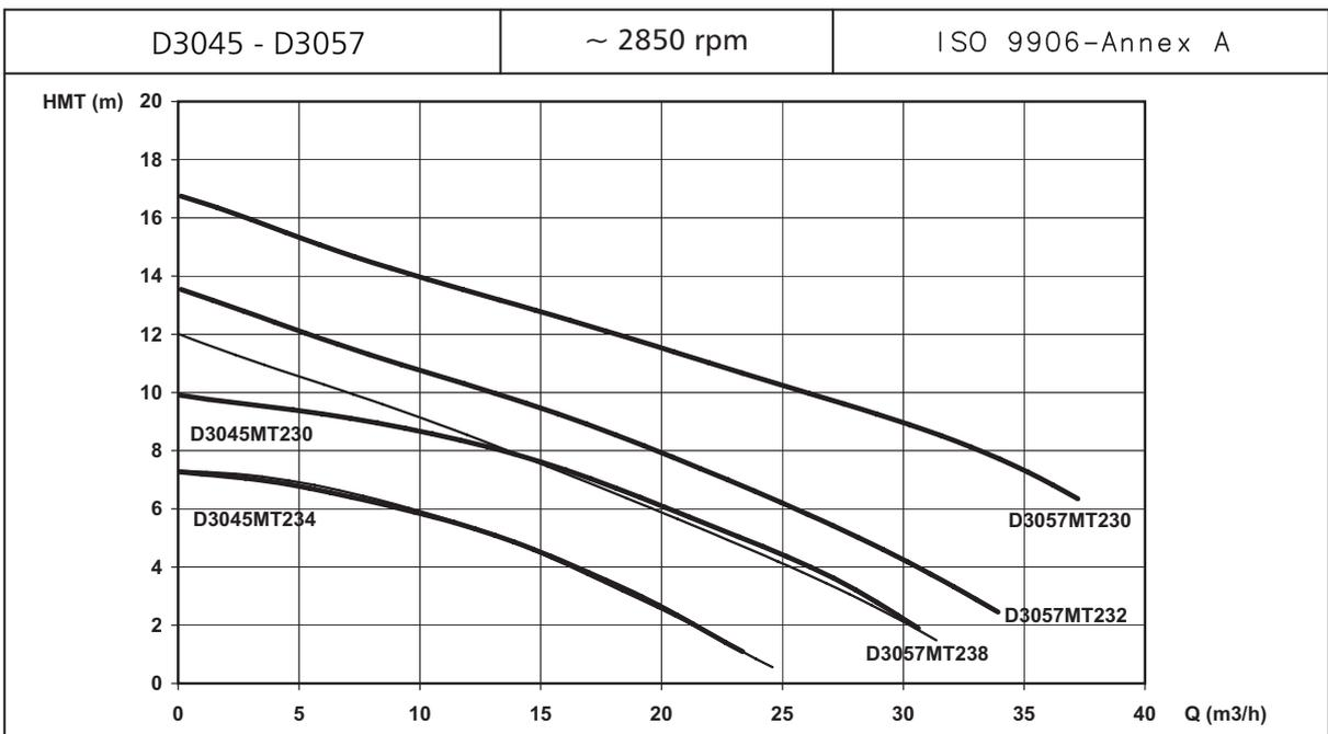
Les performances déclarées sont valables pour des liquides ayant une densité  $\rho = 1.0 \text{ kg/dm}^3$  et une viscosité cinématique  $\nu = 1 \text{ mm}^2/\text{s}$ .
