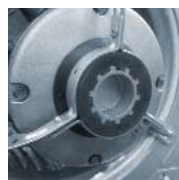
Moteur sur plots antivibratiles
